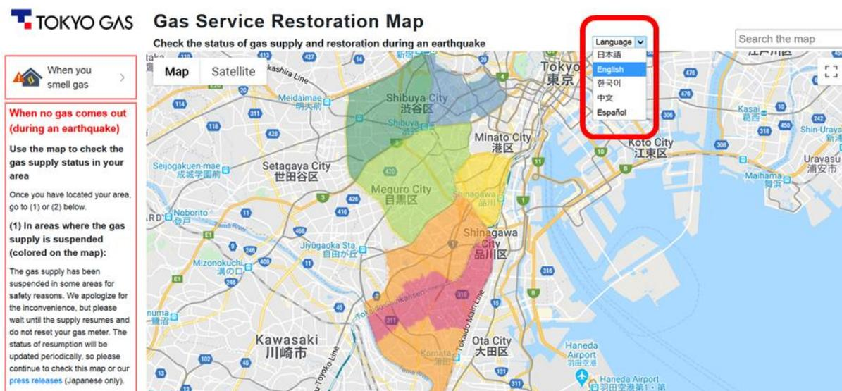
東京ガスは、供給エリア内に約4,000基の地震計を設置しており、大規模な地震発生に伴い、地震計がガス管に被害を及ぼすような大きな揺れを感知すると、二次災害を防止するために自動的に地域へのガスの供給を停止します。また、供給を停止しなかった地域でも、被害が大きいと推定された地域は、東京ガスからの遠隔操作によりガスの供給を停止します。
