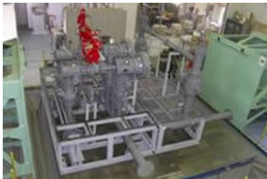
「三次元震動台」による耐震性試験
