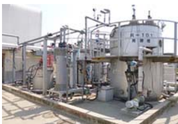
研究所構内に設置したメタン発酵パイロットプラント
