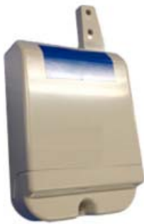
多段中継無線機の外観
