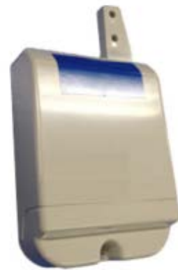
多段中継無線機の外観
