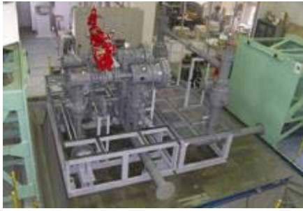
「三次元震動台」による耐震性試験
