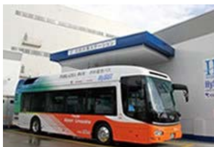
羽田水素ステーションでは、空港と都心を定期運行する燃料電池バスに水素を供給
