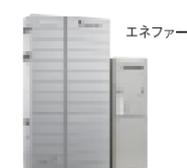
※エネファーム1時間定格運転時の発電量(0.75kWh)と熱回収量(1.08kWh/約37℃/40℃)を従来システムでまかなった場合との比較。「エネファーム」発電効率39.0%(LHV)、35.2%(HHV)、「エネファーム」熱回収率56.0%(LHV)、50.6%(HHV)、従来型給湯器熱効率80%(HHV)、ガス:45MJ/m<sup>3</sup>、2.29kg-CO<sub>2</sub>/m<sup>3</sup> 電気:9.76MJ/kWh、0.69kg-CO<sub>2</sub>/kWh
