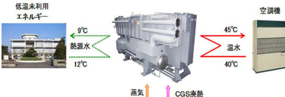
「蒸気焚き冷温水同時供給型二重効用吸収ヒートポンプ」の概要
