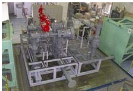
「三次元震動台」による耐震性試験
