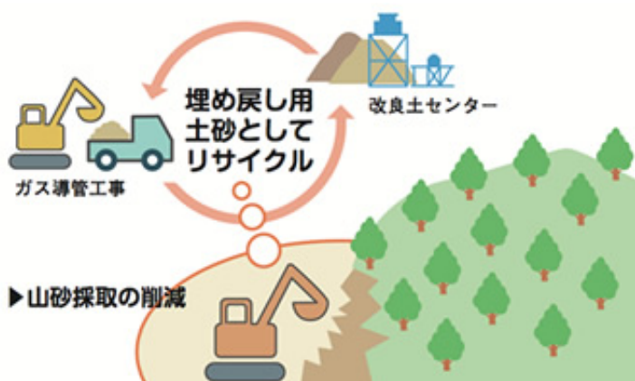
ガス導管工事で発生した土砂（掘削土）は改良土センターで再生処理し、埋め戻し用土砂として再利用。山などの生態系保全に貢献しています
