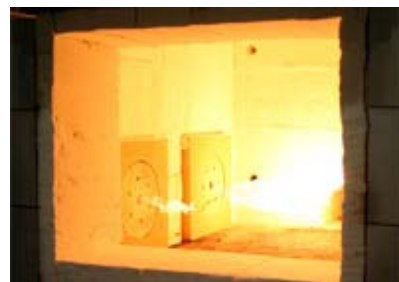
最大で50%の省エネルギーを実現する工業炉用高効率バーナ「リジェネレイティブバーナシステム」
