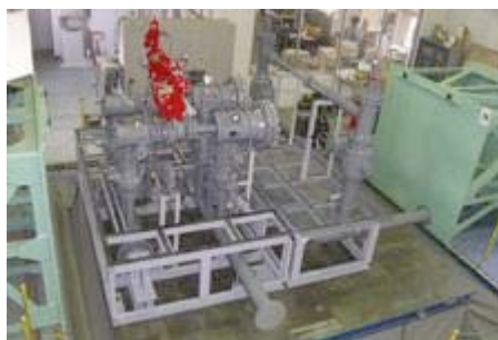
「三次元震動台」による耐震性試験
