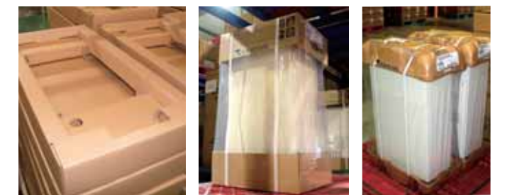
形状を工夫し緩衝材を削減したダンボール
