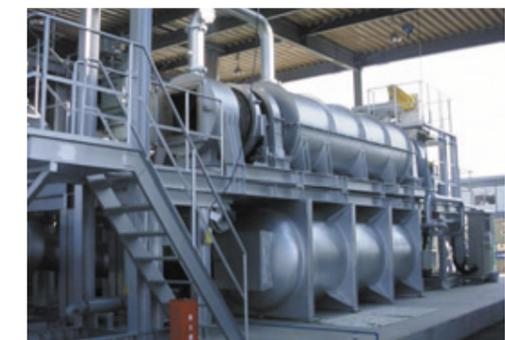
間接加熱処理炉
