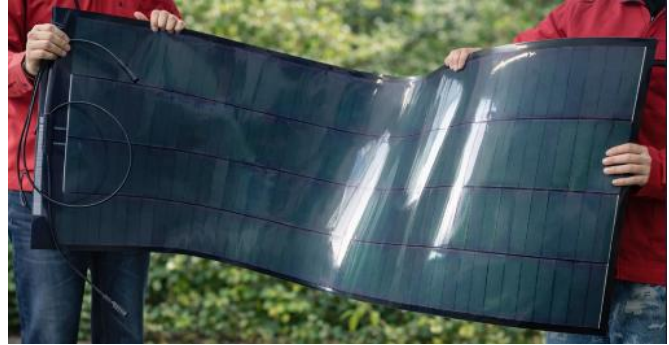
<設置するフィルム型カルコパイライト太陽電池 提供：株式会社 PXP>
