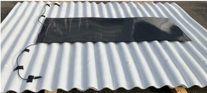
スレート屋根への設置に関する予備試験の様子
