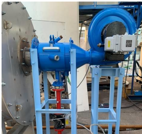
アスファルトプラント用水素バーナ (乾燥・加熱用途)
