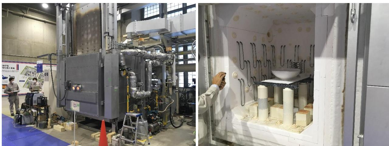
東京ガス試験場におけるセラミック焼成水素燃焼試験の様子
