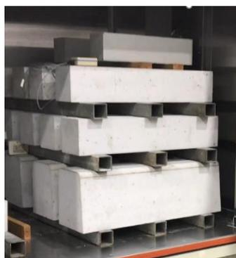
試験製造したCO<sub>2</sub>吸収コンクリート
