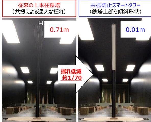
注) 1/100模型にて実験を実施 (変位と風速は実スケール換算)
