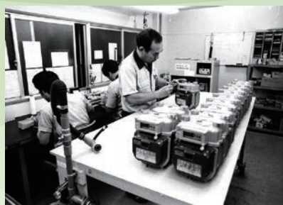
安全機能付きガスメーター「マイコンメーター」を開発（1983年完成）
