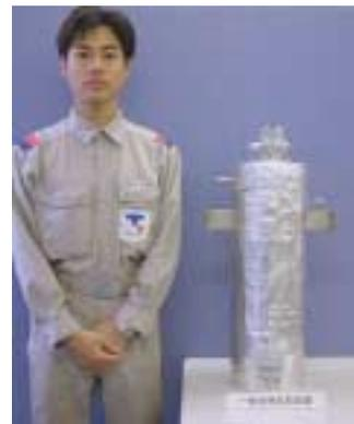
世界最高の熱効率と装置の小型化を実現した一体型燃料処理器外観
