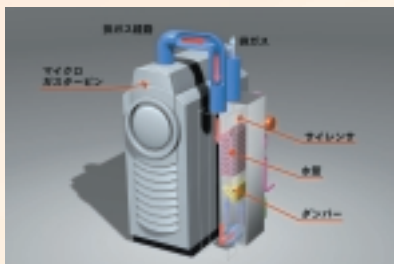
マイクロガスタービンコージェネレーションの仕組み
