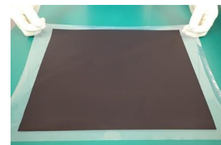
電極面積800 cm 2 超の水電解用CCM
