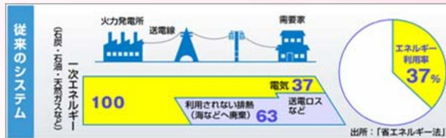
発電所と需要地が離れていて、発電時に発生した熱を利用できないため、海などに捨てています。
