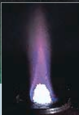
メタンハイドレートの燃焼実験:東京ガスは、21世紀のエネルギー資源として期待されているメタンハイドレート利用技術の研究を進めています。
