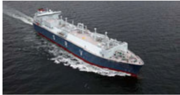
船上再ガス化装置付LNG船
