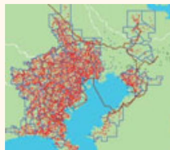
地震センサー配置図 (赤点：東京ガス分 青枠：防災ブロック)
