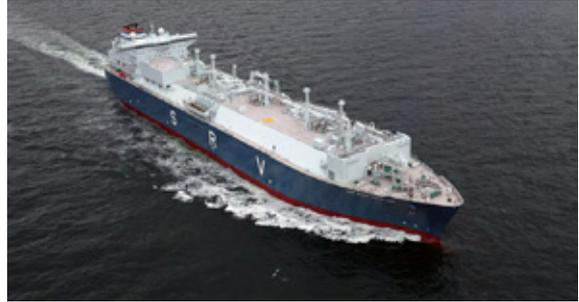
船上再ガス化装置付LNG船
