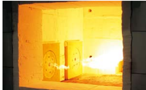
リジェネレイティブバーナシステム 工業炉から排出される高温の排気ガスを効率よく回収し、燃焼用の空気を予熱するシステム。省エネルギー・省CO 2 技術の切り札として注目されている。
